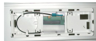
Bild 5 Anschluss des Lichtleiters (wird bei Bedarf vorher gemacht)
