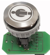
Ruftaster-Einheit mit steckbarer Platine TA-099-320-61 (AS/RS)
